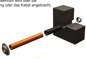
The cover flanges are screwed down until they are flush with the partiton surface. Die Abdeckflansche werden beitseitig bis zur Wandung aufgeschraubt.
