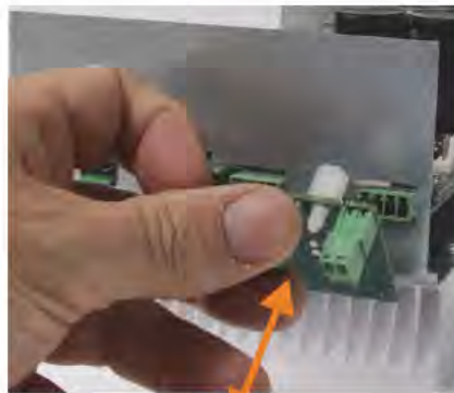
Montieren und klicken Sie in das Loch über den Modbus-Terminals Mount and click in to the hole above the Modbus terminals
